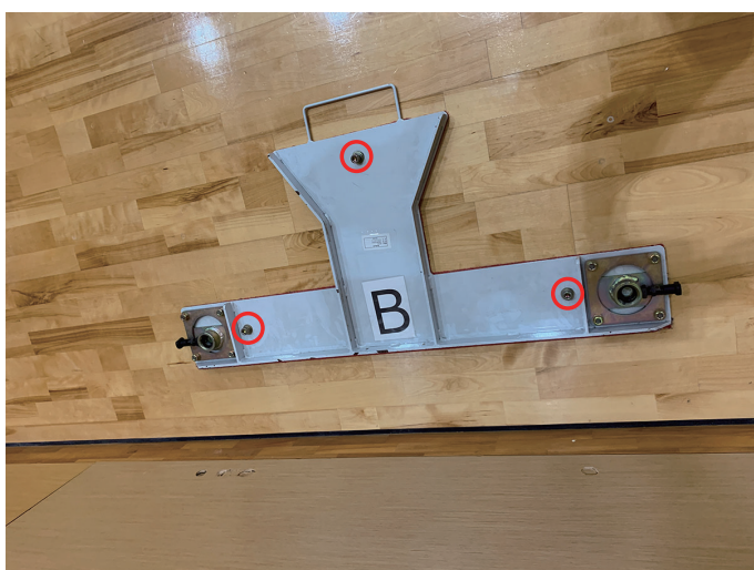
前側のベースは傷防止のためフェルトを下にする
